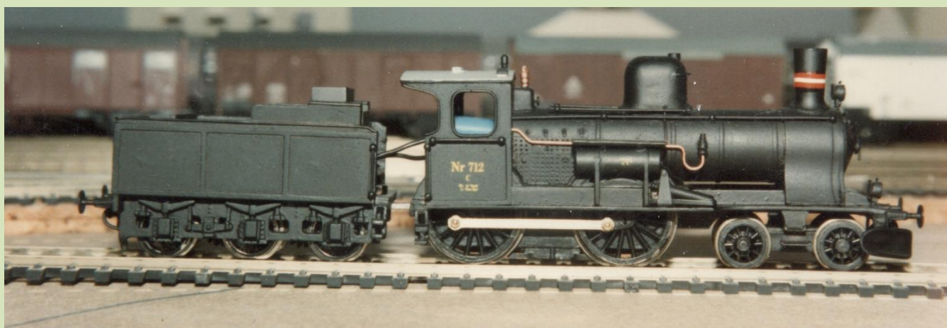
C maskinen er ikke mindre smuk, men lider af de samme problemer som P og E. Den blå "dime" i førerhuset er såmænd et af fire bananstik (meget midlertidige) til strømovertførsel til det dengang nyindbyggede tenderdrev. Bemærk at der heller ikke er lavet fast forbindelse mellem tender og maskinen!
