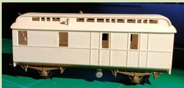
DP 5656 fra Banetjenesten tilsat messing akselgafle, fjedre og fine Perl stjerne hjul. Ætset gavlstiger og højt siddende bremsesving. Dejlig model! Bortset fra malearbejdet er det tæt på færdig. Ud over stumperne på foto, skal der laves balustre, dør håndtag og sikkert lidt mere!
