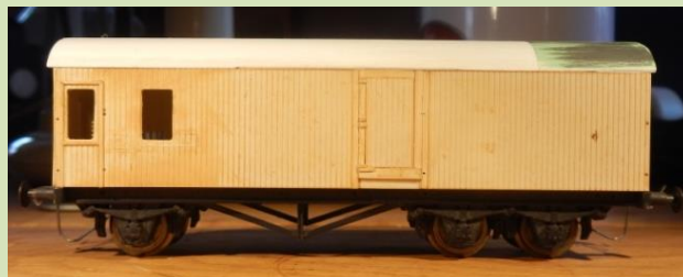
ZM 500 401. Endnu en fælles opgave med Jørgen, det er en skøn model, der nok kan give sine konstruktører dårlige nerver! Så længe der bliver kørt på Code 100 spor er der "no problemas" men på Code 83 spor ryger den af i de korte skifter! Løsningen er en afdrejning af Hjulfangerne på midterakslen.
