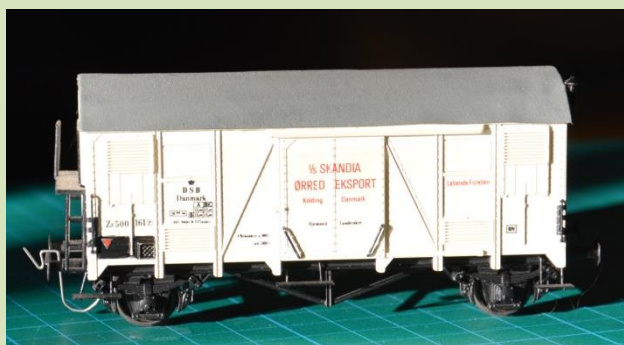
Næh det er ikke en Heljan vogn, men en Liliput IAL vogn med diverse påsatte håndtag nye trin og strækbånd og lige et par små detaljer her og der!
